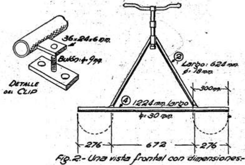
Supóngase el lector que ya va a comenzar el trabajo; se toma el armazón de la bicicleta y se le corta la horquilla delantera. Se corta también la horquilla trasera que va desde el soporte del asiento hasta el cubo de la rueda, pero se deja la horquilla horizontal que va desde el travesaño de los pedales hasta el cubo de la rueda trasera.
