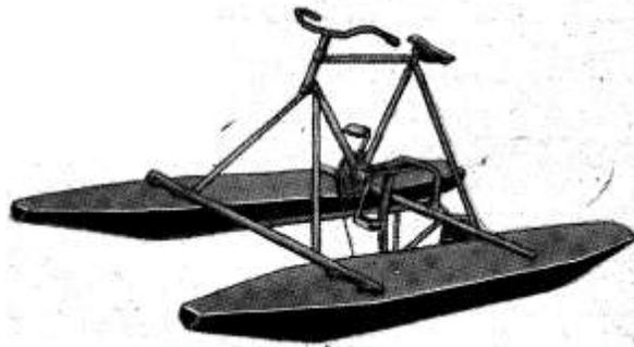
Dándole un vistazo a la ilustración de la figura 1, se puede apreciar el aspecto que presentará la máquina una vez terminada, así como también la forma en que trabaja. Se verá que se construye en parte con una bicicleta vieja. La pieza que lleva el No. 12 es una caja de engranajes colocada en forma tal, que al mover los pedales se hará girar a la hélice, para así conseguir la propulsión.
