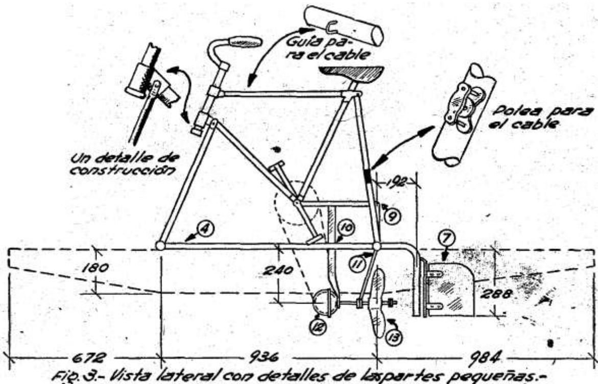
Se preparan las partes (4), las que son dos tubos de 1m 224 de largo por 30 mm. de diámetro exterior. Se conectan por un tubo similar (6) de unos 946 mm de largo, de modo tal que los tres tubos formen una H, una vez soldados.
