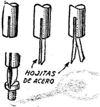
A veces hay que acercar un tornillo a lugares inaccesibles para los dedos y, entonces, se pierde mucho tiempo en acomodarlo con el destornillador para embutirlo.
