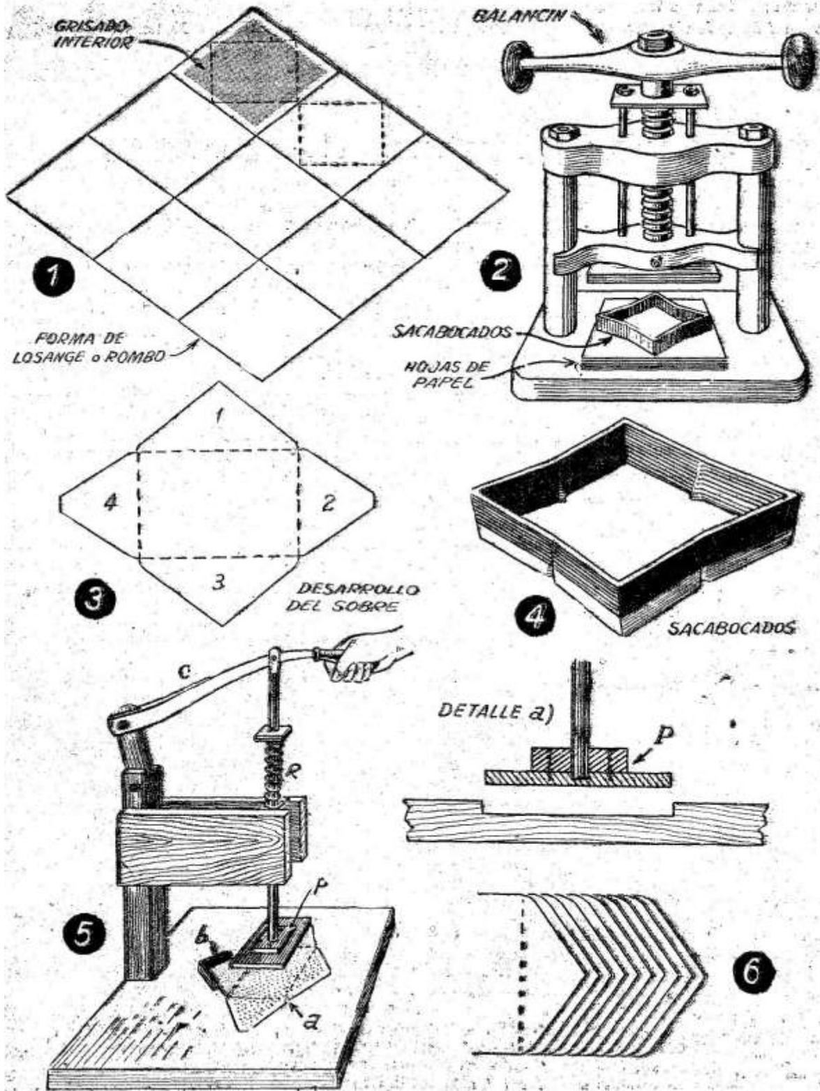
La parte inferior termina en filo cortante, siendo su aspecto, una vez terminado, parecido al de los moldes que se usan en pastelería para cortar bizcochos y galletitas, etc. Para operar se coloca el
