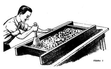
Con los nombres de mármol artificial o mármol reconstituido, se presentan en la industria de la construcción planchas de conglomerado constituido por desperdicios de mármol natural reducidos a pequeños trozos de 2 a 5 milímetros de diámetro, unidos fuertemente por medio de cemento y coloreados O no con colorantes minerales.
