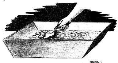
engrasar la superficie de la mesa dentro de los límites del molde, y el molde mismo en su parte interna. Esto se hace para evitar que la composición de la masa, al fraguar, se adhiera fuertemente a la mesa y a las paredes del molde e impida su separación al desmoldar.
