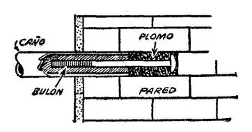
Las paredes de cemento o ladrillo siempre presentan un problema cuando se desea colocar prisioneros, bulones o tornillos. Con el método que describo se facilita mucho la labor.
