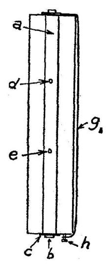
Cuanto se necesita ahora para terminar el cilindro, es un pedazo de elástico, ancho y chato (g), que por una punta se asegura al rodillo y por la otra tiene un pequeño ojal o arandela de alambre, que pasa sobre la cabeza del clavo (h), en el extremo de la varilla o rodillo. El largo de este elástico debe ser tal, que cuando sus dos extremos estén fijos, quede en tensión. El objeto de éste es que ejerza presión sobre las corbatas enrolladas, e impida que se desenvuelvan.
