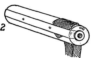
Se corta una banda de goma de una cámara vieja, de bicicleta; las medidas son 220 mms. de largo por 9 de ancho, y se estira sobre la varilla, gobio en (a), en la figura, asegurando cada una de sus puntas sobre un pequeña vástago de cabeza grande (b). Entre la cabeza y la goma se coloca una arandela (e) cuyo objeto es distribuir la presión y evitar que la goma ejerza toda su tensión sobre la cabeza.
