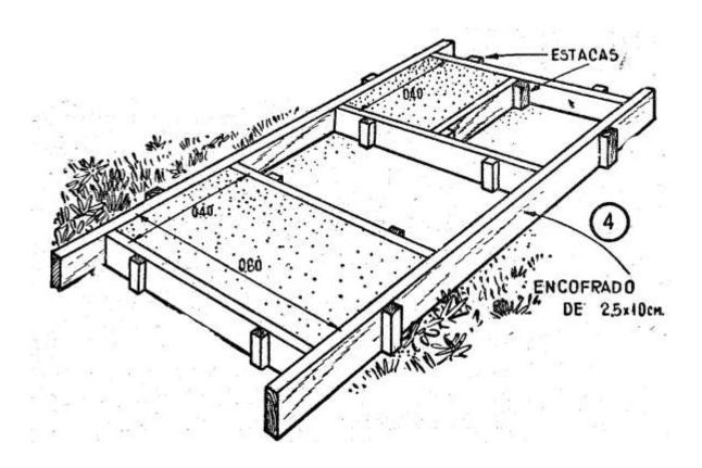
Para lograr uniformidad en el grosor de las lajas se nivelará el terreno alisándose lo mejor posible. Si el granulado no es muy grueso puede emplearse el listón de nivelar para acabar las losetas (fig. 3). Un encofrado que se haga con listones de 2,5 cm. por 10 cm. y para contener tres o cuatro lajas será muy práctico (ver fig. 4).
