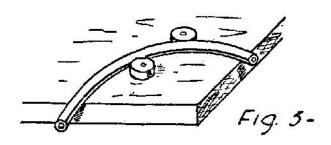
Cuando haya que curvar pequeños tubos de latón, de menos de 1 centímetro de diámetro, se emplea el bloque de madera perforado, que se asegura a la morsa. El tubo se introduce en el orificio que le corresponda por su diámetro, y luego, por medio del soplete, se lo calienta en los
