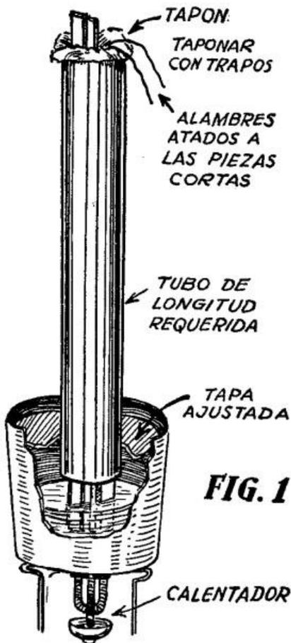
Las dimensiones y cantidad de las piezas a curvar pueden sacarse del plano del bote a construir. Una de las maderas más aptas para ser curvadas, es el roble blanco. Evítese roble muy seco para disminuir las probabilidades de que se quiebre. En cualquier aserradero pueden conseguirse unas pocas planchas de roble blanco de vetas rectas y sin nudos, que se pueden hacer cortar a medida.
